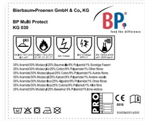
Das Innere einer Schutzkleidung gleicht einem Bilderbuch! Und das hat einen guten Grund: Der Träger der Kleidung muss über die Eigenschaften „seiner“ Persönlichen Schutzausrüstung informiert sein. Daher ist jedes Teil mit Symbolen ausgestattet, die die Kleidung genau charakterisieren.
